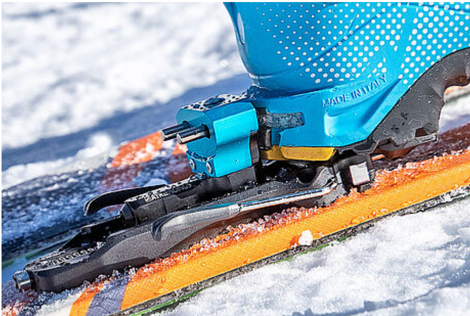
Filigraner Hinterbacken der ATK Candy 5, an dem die Z-Wert-Einstellung vorgenommen wird.
